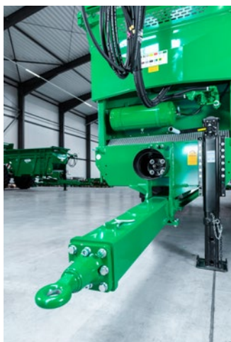
Image à gauche : L'attelage par le bas standard avec anneau de timon de 50 mm. Les composants du véhicule sont protégés contre les influences extérieures par un cache.
