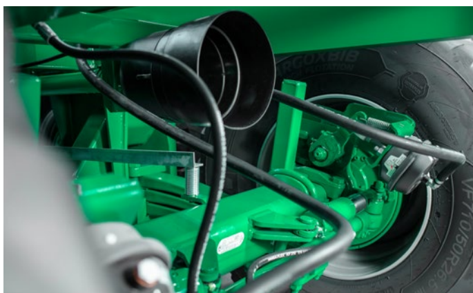
Le lourd châssis bogie BPW avec régulateur ALB fait partie de l'étendue standard du HS 220.
