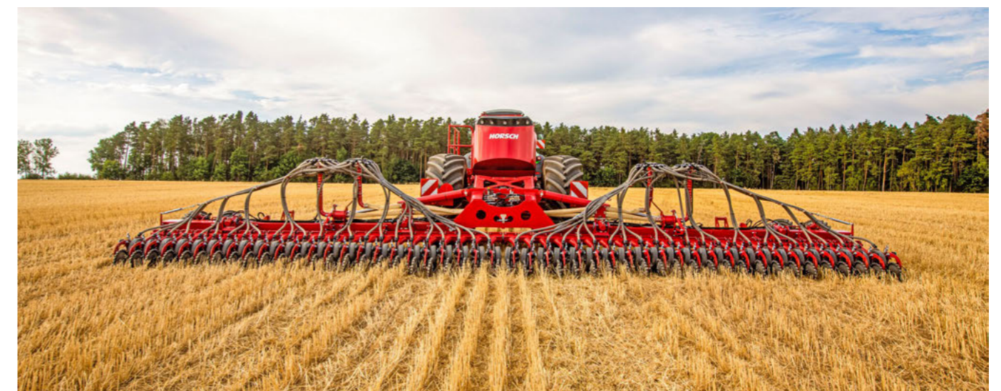
Quatre têtes de répartition pour une répartition sélective des descentes de graines
