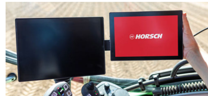
Grâce à la fixation adaptable, l'eosT10 peut être parfaitement intégré dans chaque cabine
