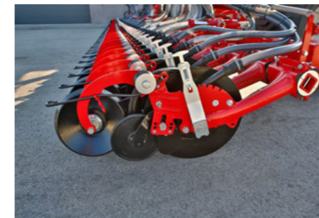
SingleDisc – Parfaite adaptation aux conditions du sol grâce à la roue de terrage
