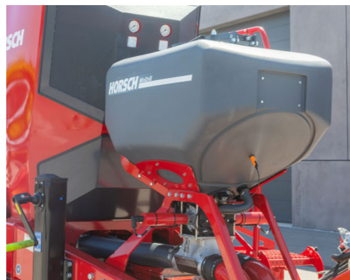
Appliquez jusqu'à quatre produits grâce au MiniDrill de 400 l
