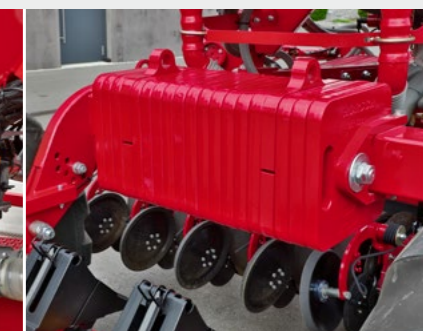
Masses supplémentaires en option pour augmenter la pression de chaque élément semeur
