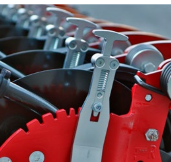
Réglage de la profondeur de semis sans outils par crémaillère fine
