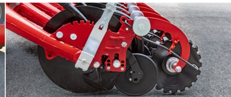
Roue de fermeture étoile en acier – produit de la terre fine et referme le sillon
