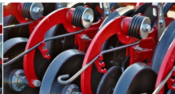
La pression des roulettes de fermeture est réglable sans outil via un système à ressort.
