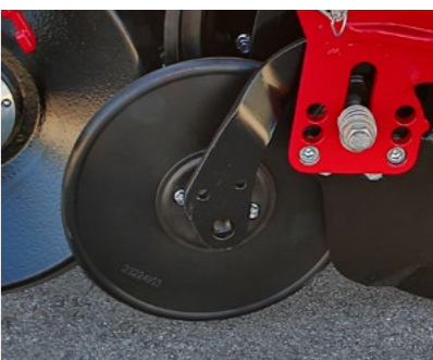
Roue de plombage dans le sillon pour un contact terre/graine optimal
