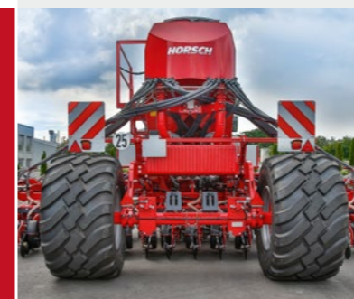
Option : pneumatiques 710/50–26.5 pour la préservation des fourrières lors des demi-tours
